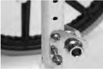
Bild 1: Hjul monterade på ramen
