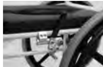
Ill. 4: Montage des freins sur le cadre
