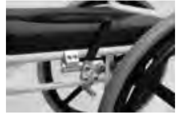
Bild 4: Montering av bromsarna på ramen
