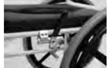
Fig. 4: Montaggio dei freni sul telaio
