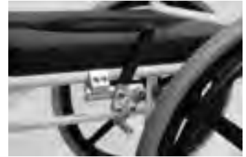
Fig. 4: Montering af bremsen på rammen
