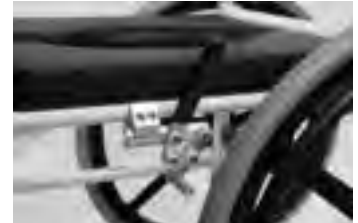
Abb. 4: Befestigung der Bremsen am Rahmen
