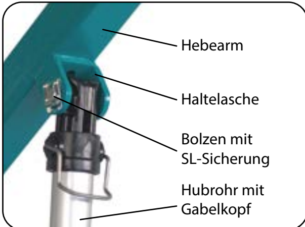
Abb.13.2.01 – Haltelasche an dem Hebearm
