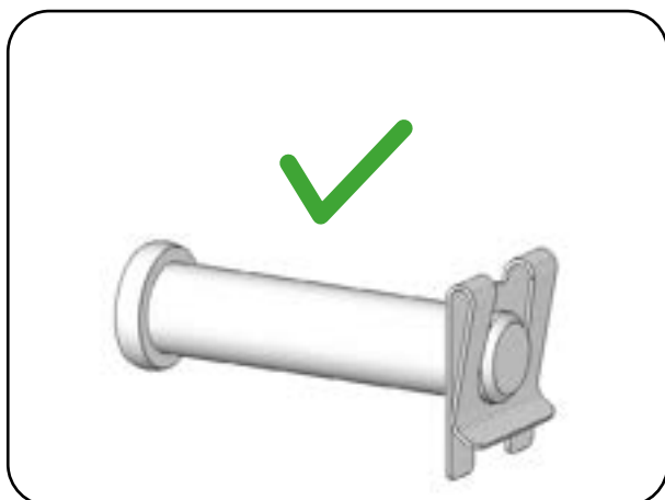
Abb. 6.1.01 - SL-Sicherung richtig montiert
